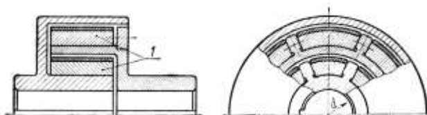
Рисунок 16 - Центробежная колодочная муфта
