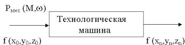
Рисунок 2 – Схема технологической машины, использующей механическую энергию для преобразования формы, свойств, размеров и состояния объекта
